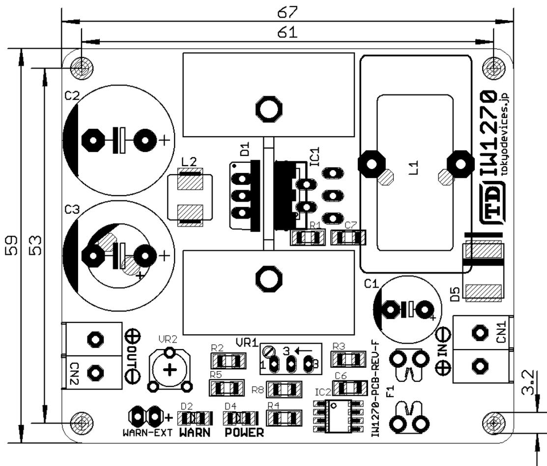
図 1 IW1270-X8 寸法・構成図
