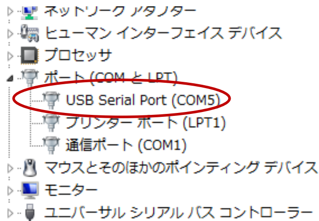
図 5 Windows のデバイスマネージャーから COM ポートを探す例
